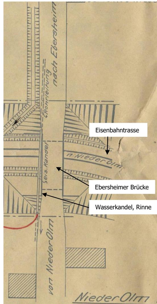
Noch im Jahr 1911 wurde das Überlaufwasser des 1892 gebauten Wasserwerks an der Ebersheimer Straße in einer Gussrinne entlang der Ebersheimer Brücke geleitet. Zum Antrieb der Bischofsmühle war die Wasserkraft jedoch zu gering.<sup>43</sup>
