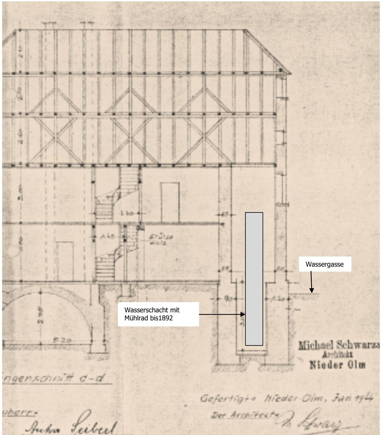
1944, Schnitt durch den Wasserschacht mit Mühlrad.<sup>47</sup>
