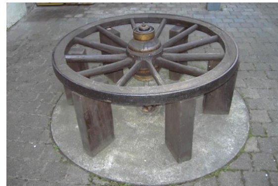
Schmiede Wettig, Enggasse 15. Wagenrad für einen Erntewagen, gefertigt von Wagnermeister Paul Debo. Der Eisenreifen wurde von seinem Schwager Schmied Georg Wettig aufgezogen und die Radnabe eingebaut. 9
